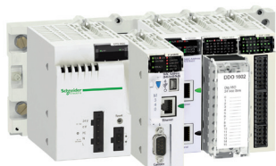
Plate-forme Modicon X80 avec processeur Modicon M340
